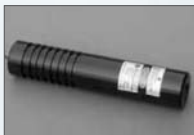
グリーン十字 出力：0.4-25mW @532nm ラインサイズ： <0.5mm@50cm, <2.0mm@6m ファンアングル：10-100°
