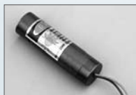
レッドライン 波長：635nm/650nm/670nm 出力：0.4-40mW ラインサイズ： <0.5mm@50cm, <1.5mm@6m ファンアングル：10-100°
