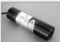
レッド十字 波長：635nm/650nm/670nm 出力：0.4-20mW ラインサイズ： <0.5mm@50cm, <2.0mm@6m ファンアングル：10-100°
